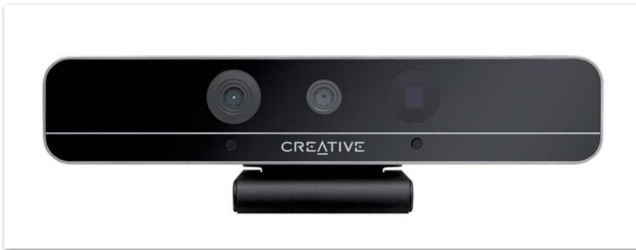
Abbildung 5: Aktuelle Intel-RealSense-Kamera (F200) in einem Gehäuse zur Verwendung als USB-Peripheriegerät (Quelle: Intel, „<http://intel.com/realsense>“)
