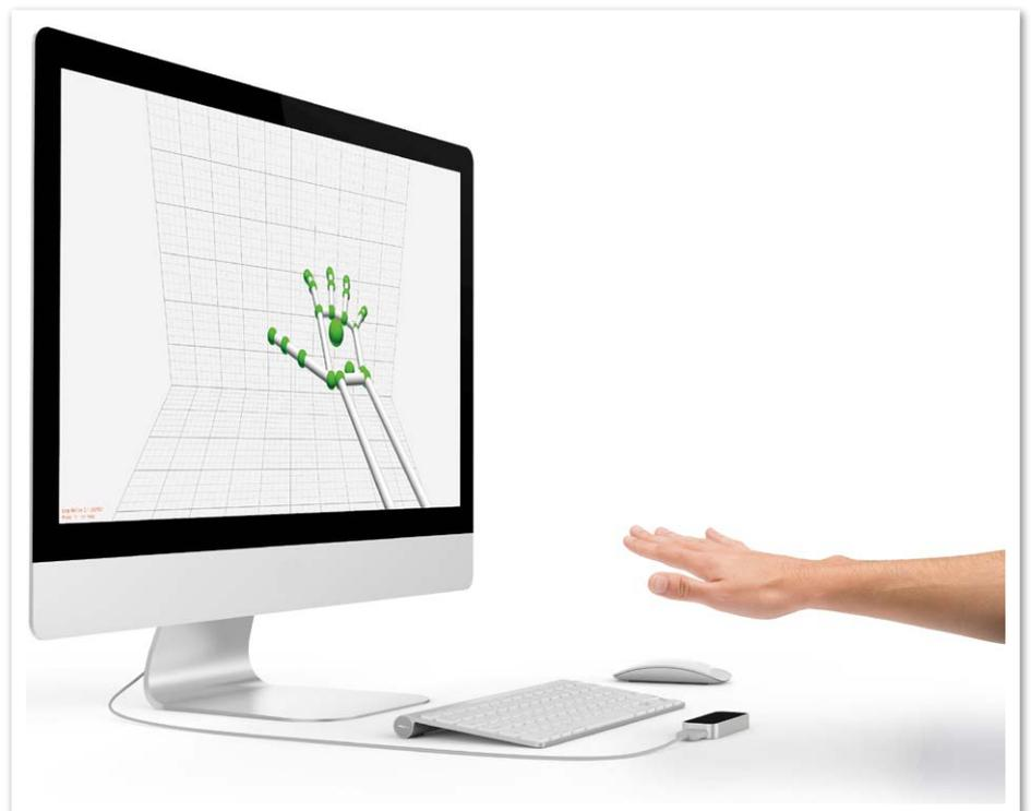
Abbildung 1: Leap Motion in Aktion mit einer über das Gerät positionierten Hand (Quelle: Leap Motion, „<http://leapmotion.com>“)
