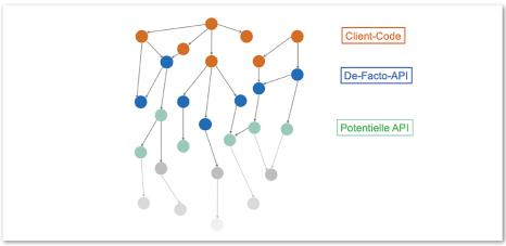
Abbildung 1: Die Objekte eines Programms bilden einen gerichteten Graphen. Die Wiederverwendung von existierendem Code erfolgt über ein De-facto-API, das nicht immer für diesen Zweck optimiert ist, aber sein sollte.
