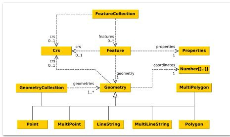
Abbildung 2: UML-Diagramm "GeoJSON"
