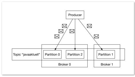
Abbildung 3: Der Producer schickt Nachrichten direkt an den verantwortlichen Broker
