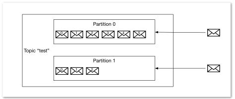
Abbildung 2: Nachrichten werden hinten an das Log angehängt. Jede Nachricht erhält ein pro Partition eindeutiges Offset.
